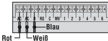
AC-Schraubklemme von links, die weiße Ader an der zweiten AC-Klemme und die blaue Ader an der R-Klemme.
